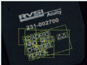
Reconocimiento de plantillas y patrones y localización de objetos con ángulo de giro
