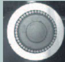
Empleo del procesamiento previo de morfología para reconocer bolas de rodamientos
